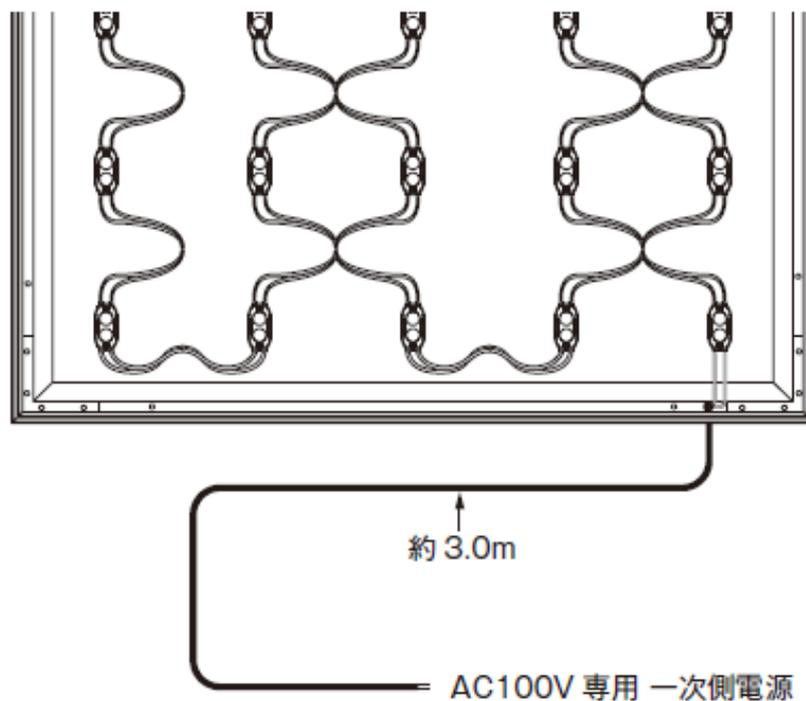
バックライト方式は通常、AC コード約 3m（差込プラグなし / 2 芯）がフレームに固定されています。壁面設置時、一次電源は回路遮断器のある屋内固定電源を使用し、有資格者による配線工事を行ってください。
